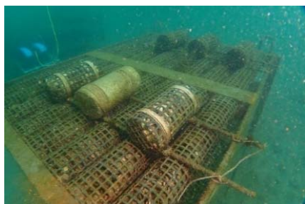
写真-2 試験礁に設置したテストピース
