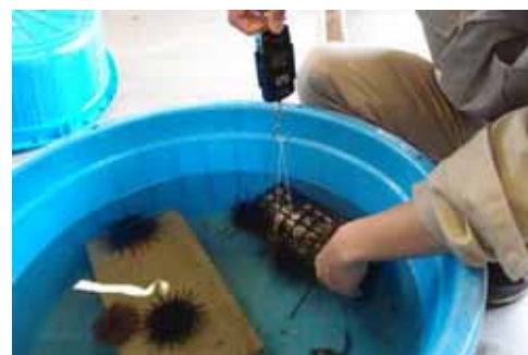
図 4 付着力実験の状況
