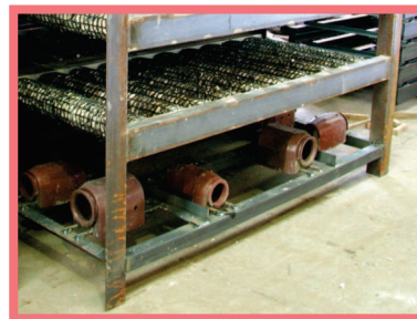
タコツボは内部パネルの 下部に取り付けています。
